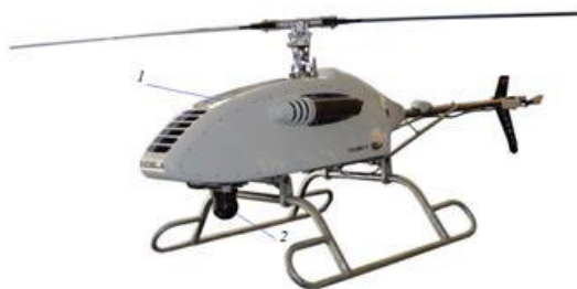
Рисунок 13 – БПЛА «INDELA-SKY», КБ ИНДЕЛА (Белоруссия) (1), Система «INDELA OGD-20HIR» (2), состоящая из четырех встроенных модулей (тепловизор, цветная камера, лазерный дальномер, инерциальный модуль). является базовой полезной нагрузкой для БПЛА «INDELA-I.N. SKY» при решении традиционных задач разведки, наблюдения и мониторинга. [“INDELA-SKY” UAV, INDELA KB (Belarus) (1), Sistema “INDELA OGD-20HIR” (2), consisting of four integrated modules (thermal imager, colour camera, laser rangefinder, inertial module). is the basic payload for the UAV “INDELA-I.N. SKY” for traditional reconnaissance, surveillance and monitoring tasks]
