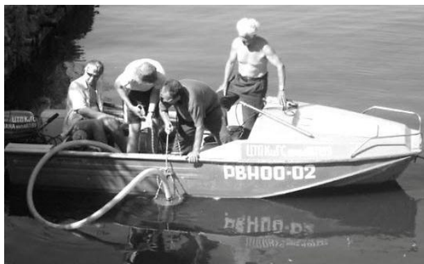
Рисунок 1 – Проведение радиационного обследования в зоне влияния утечки ЖРО из ХЖО-2 НВАЭС (1985 г.) [Radiation survey in the zone of influence of liquid radioactive waste leakage from No. 2 of Novovoronezh NPP liquid waste storage (1985)]
