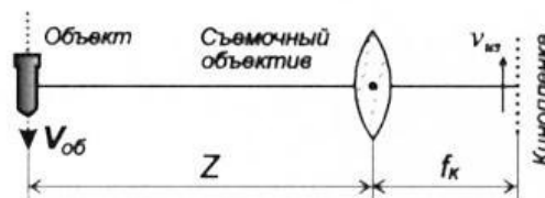
Рисунок 4 – Оптическая схема съемки [Optical design]
