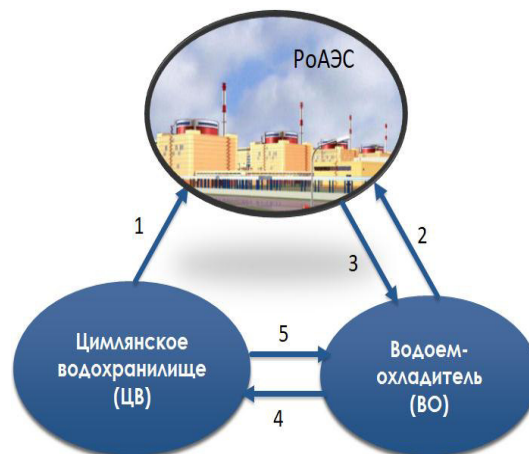
Рисунок 5 – Взаимодействие Ростовской АЭС, Цимлянского водохранилища и водоема-охладителя:
