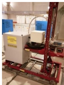
Рисунок 3 – Установка паспортизации типа УП-1 [Passporting unit type UP-1]
