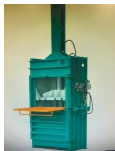
Рисунок 2 – Установка прессования ОНАО [VLLW pressing unit]
