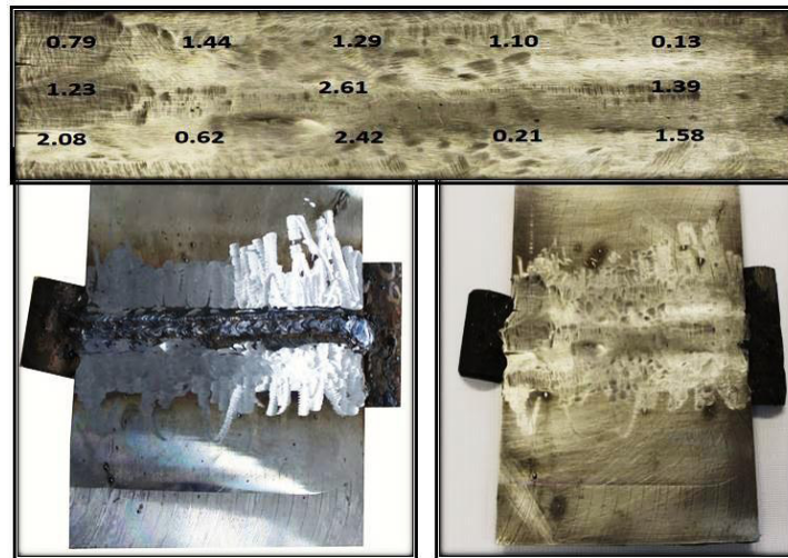
Рисунок 1 – Внешний вид образца КСС после сварки (слева). На фото справа показан образец после снятия усиления шва. Вверху на вставке выделен участок, на котором была измерена шероховатость поверхности Ra , с указанными численными значениями в мкм [Appearance of control sample after welding (left). The photo on the right shows the sample after removing the reinforcement of the seam. At the top of the inset, the area where the surface roughness Ra was measured with the indicated numerical values in \mu\text{m} ]
