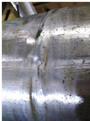
Рисунок 1 – Поверхность сварного соединения СС_1 перед проведением электрофизических измерений [The surface of the welded joint СС_1 before carrying out electrophysical measurements]
