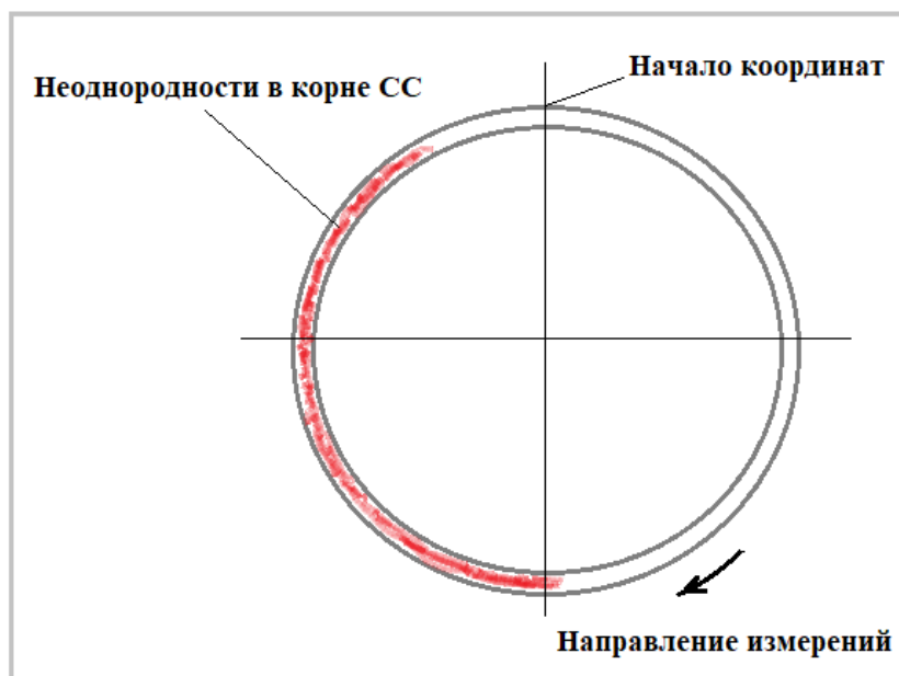
Рисунок 13 – Распределение неоднородностей в корне СС по результатам обоих методов НК в сечении перпендикулярном оси трубопровода [Distribution of inhomogeneities in the CC root according to the results of both methods in a section perpendicular to the pipeline axis]
