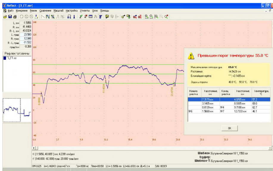
Рисунок 5 – Теплограмма плавки гололеда переменным током. ВЛ 110 кВ Зимовники-Ремонтное [Thermogram of ice melting by alternating current. VL 110 kV Zimovniki-Remontnoye]
