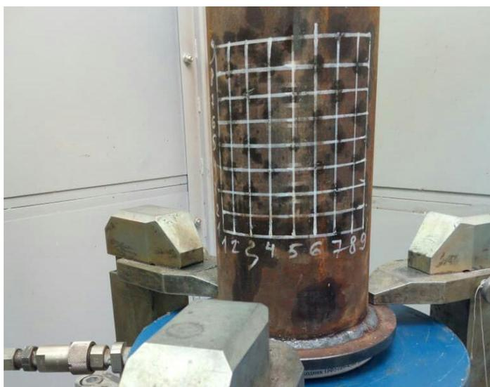
Рисунок 1 – Фотография опытного образца с координатной сеткой на стенде
