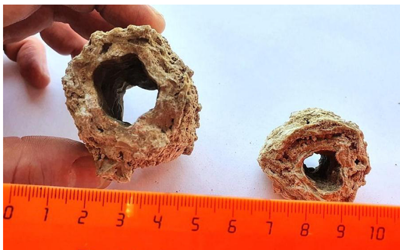
Рисунок 2 – Карбонаты (ППР-2020) из трубопровода, соединяющего конденсаторы энергоблока №2 и эжекторы циркуляционной системы [Carbonates (PPM-2020) from the pipeline connecting the condensers of power unit No. 2 and the ejectors of the circulation system]
