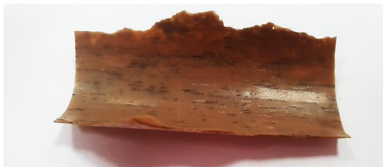
Рисунок 1 – Карбонатные отложения из конденсатора 13Б энергоблока №2, извлечённые во время ППР-2020 [Carbonate deposits from condenser 13B of power unit 2 recovered during PPM-2020]
