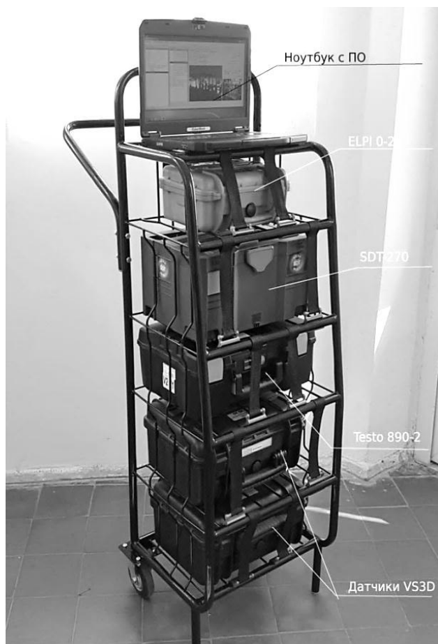
Рисунок 7 – Переносной программно-технический комплекс диагностирования дизель-генераторных установок [Portable software and hardware complex for diagnostics of diesel generator units]
