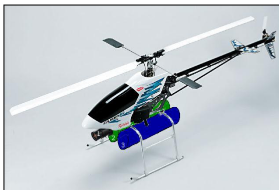
Рис. 1. Общий вид беспилотного дозиметрического комплекса на базе беспилотного радиоуправляемого летательного аппарата (БПЛА) вертикального взлета и посадки JR GSR 260Z (производства Японии). На аппарате имеются видеокамера, детектор гамма-излучения, гамма-спектрометр (ксеноновый гамма-спектрометр).
