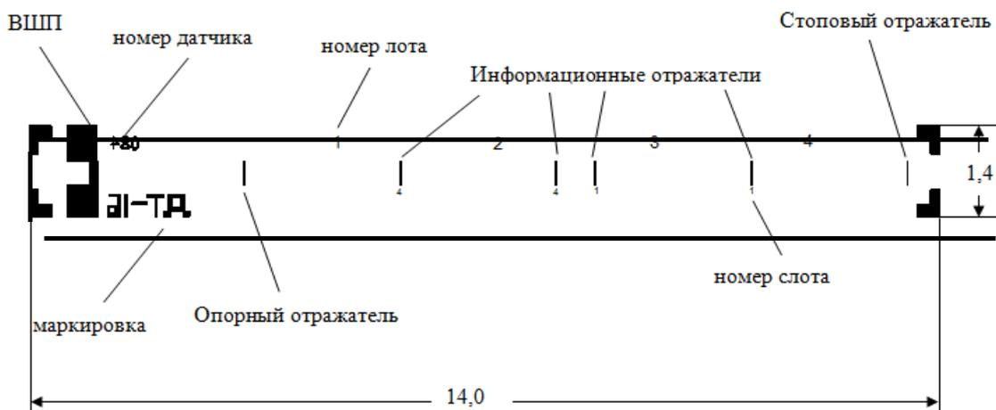
Рис. 1. – Конструкция датчика температуры
