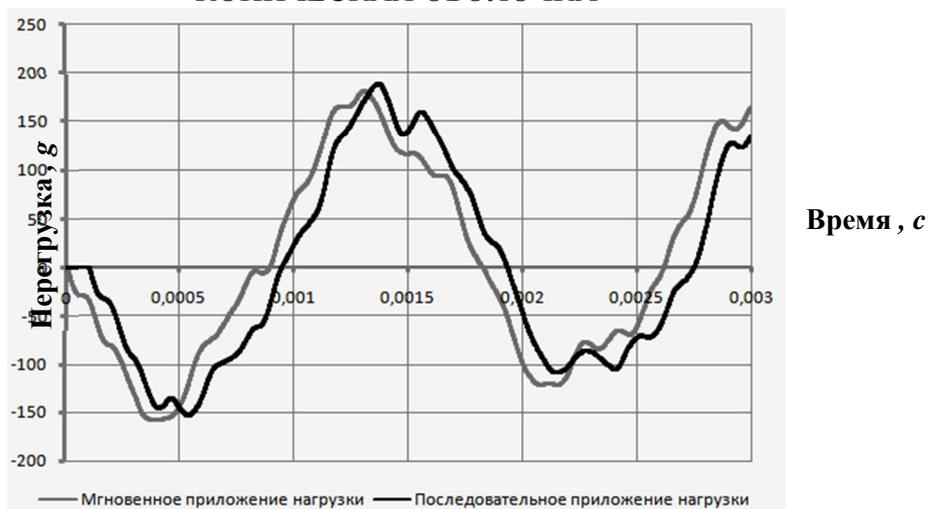
Рис. 7. – График перегрузки точечной массы  $m=10$  кг, подвешенной на упругих элементах
