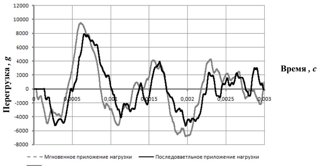
Рис. 9. – График перегрузки точечной массы  $m=10$  кг, находящейся в центре поперечной пластины
