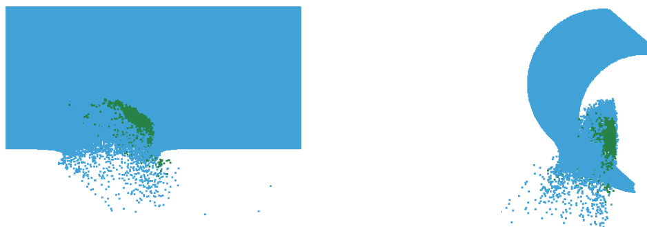
Рис. 2. – Результат соударения осколка с корпусом со скоростью 2000 м/с
