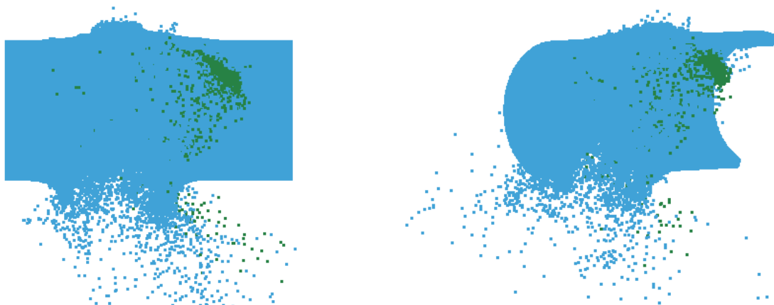
Рис. 3. – Результат соударения осколка с корпусом со скоростью 3000 м/с
