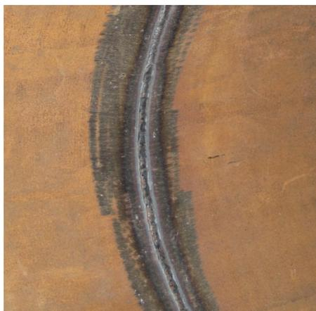
**Рис. 4.** – Внешний вид обратного валика шва
