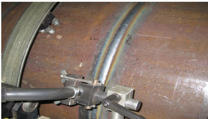
Рис. 7. – Облицовочный валик шва трубы 530x8мм
