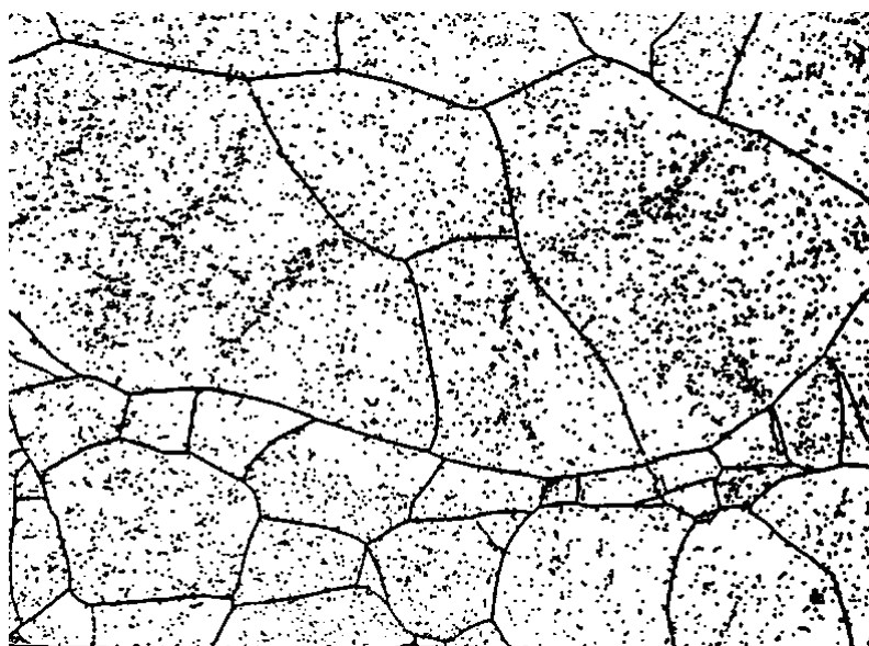
Рис. 5. – Субструктура монокристалла вольфрама в исходном состоянии; \times 80
