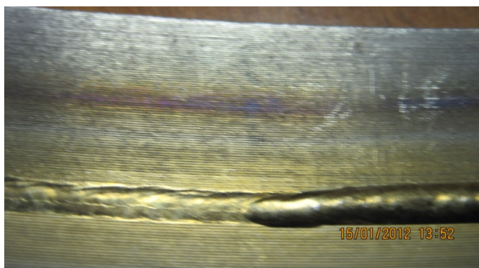
Рис. 8. – Корневой валик при сварке неплавящимся электродом
