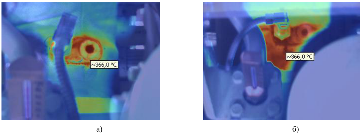
Рис. 1. – Выпускной патрубок 6-го цилиндра правая сторона: а – 2РДЭС-3; б – 2РДЭС-3
