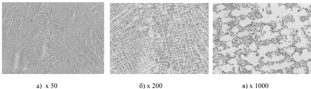
Рис. 1. – Микроструктура металла сварного шва, сталь 04Х14ТЗР1Ф-Ш. Сварочные материалы – проволока Св-03Х19Н60М15 + керамический флюс
