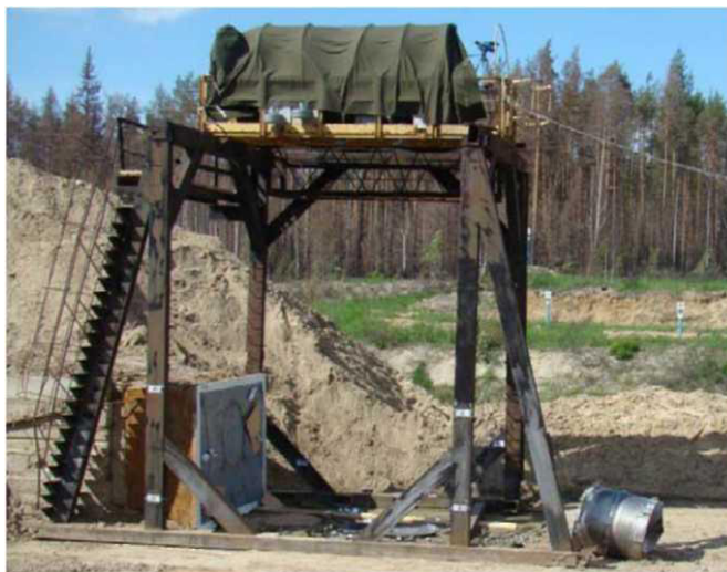
Рис. 6. – Вид площадки после столкновения макета ТУК-145/С с мишенью
