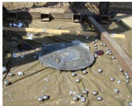
Рис. 8. – Верхняя плита корпуса ТУК-145/С (вид сбоку) макета ТУК-145/С
