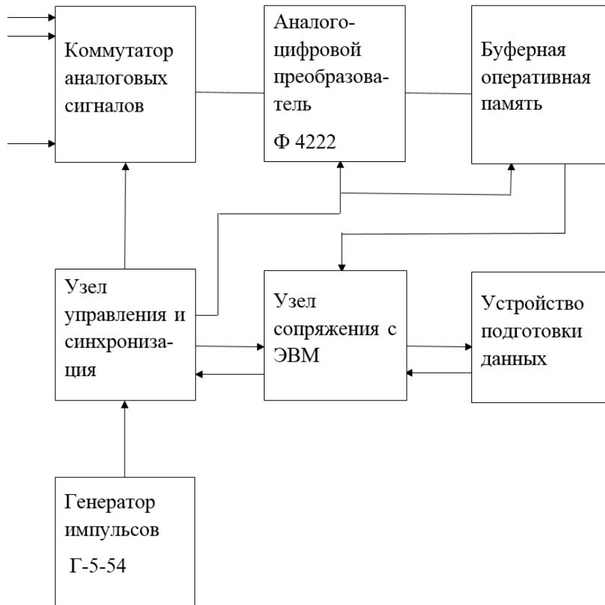
Рис. 2. – Электрическая структурная схема измерительно-регистрирующего комплекса [Electrical structural scheme of the measuring and recording complex]
