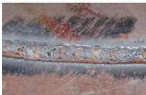
Рис. 2. Обратный валик выполненный металлопорошковой (слева) и рутиловой (справа) порошковыми проволоками
