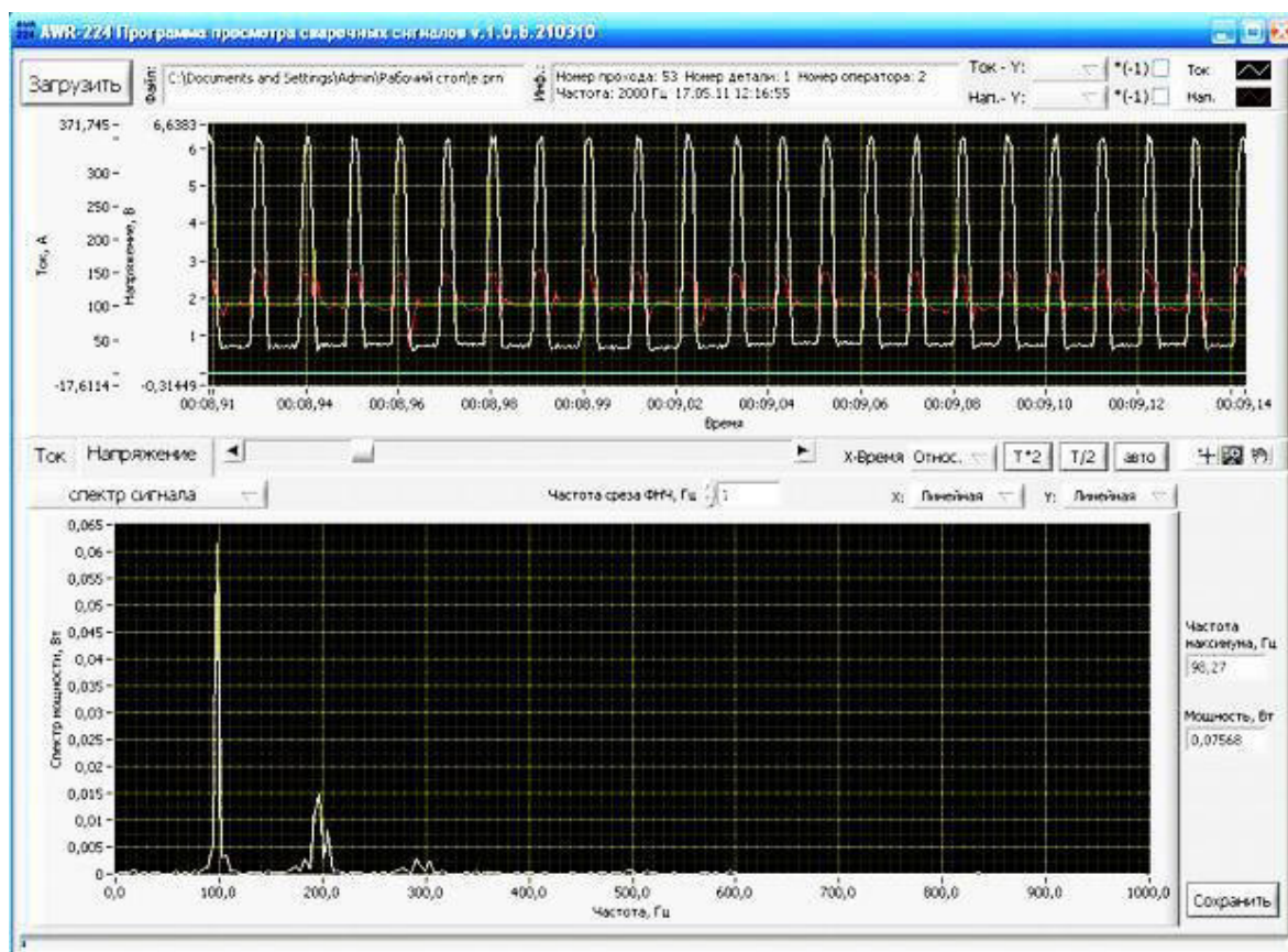
Рис. 1. Осциллограмма и АЧХ режима сварки Esab Pulse
