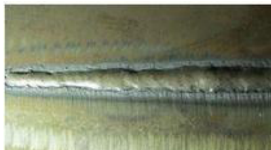
Рис. 2. Обратный валик выполненный металлопорошковой (слева) и рутиловой (справа) порошковыми проволоками
