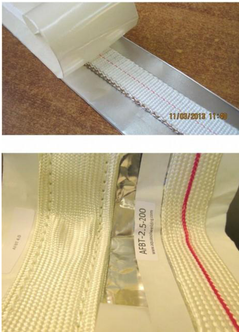
Рис. 4. Подкладная лента ЛФС (сверху) и Aquazol (снизу)
