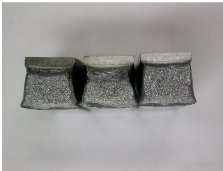
Рис. 6. – Вид излома образцов с острым надрезом из стали 10ГН2МФА, испытанных на ударный изгиб при комнатной температуре в полосе разброса в верхней части интервала ВХП. Вверху под надрезом видна зона подрастания вязкой трещины, различающаяся для всех приведенных образцов; в центре – блестящая зона макроскопически хрупкого разрушения; по бокам участки среза; внизу – вязкая зона сжатия. Профиль излома имеет искаженную деформацией форму
