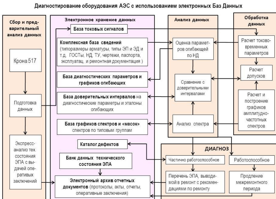
Рис. 1. – Схема организации мониторинга и диагностирования оборудования АЭС с использованием электронных баз данных
