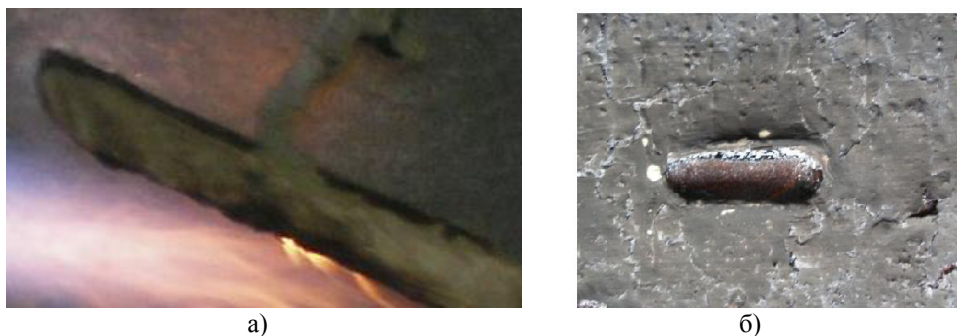
Рис. 3. – Образец ТЗП с дефектом а) В период эксперимента; б) после эксперимента
