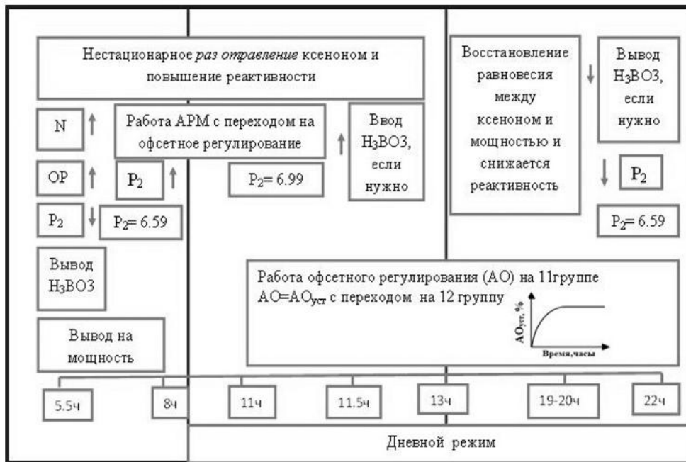
Рисунок 4 – Алгоритм управления реактором в дневном интервале времени для реализации суточного маневренного режима при минимизации водообмена [Algorithm for controlling the reactor in the day time interval for the realization of the daily maneuvering regime with minimization of the water exchange]
