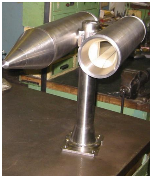
Рисунок 5 – Датчик мощности радиоактивных выбросов, состоящий из непроточной (с конусом), проточной (с каналом) ионизационных камер и кронштейна [8]
