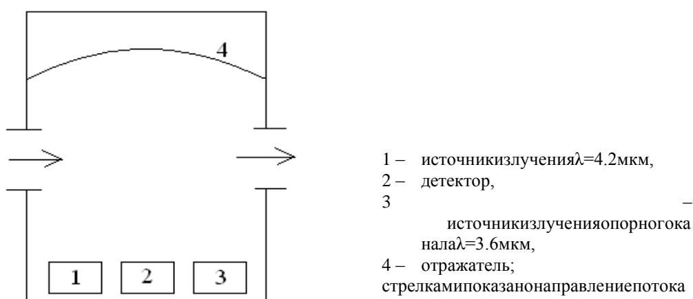
Рисунок 1 - Устройство газового сенсора
