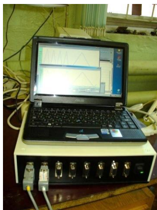
Рисунок 4 – 8-канальный вторичный преобразователь с ноутбуком для измерения временных характеристик сигнала с датчиков
