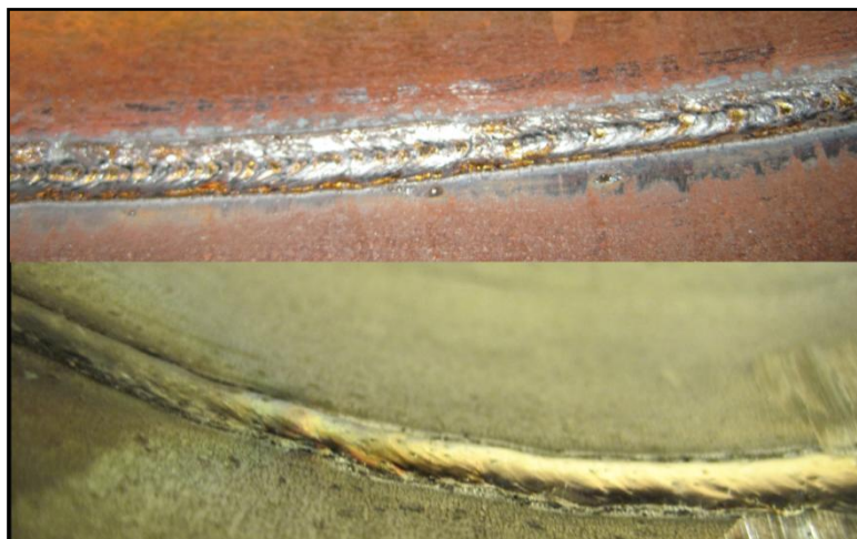
Рис.5. Обратные валики шва при сварке способом SteelRoot (сверху) и на подкладной ленте ЛФС (снизу)
