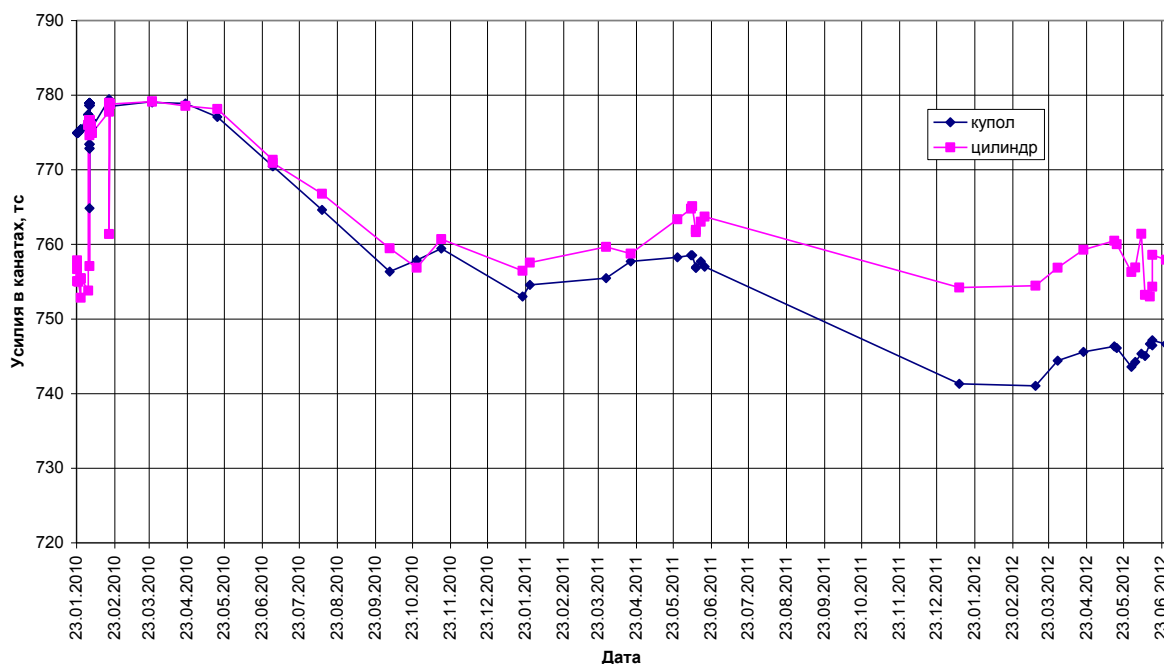
Рис. 2. Средние значения усилий на тяжных анкерах арматурных канатов цилиндра и купола защитной оболочки за период с 23.01.2010 по 26.06.2012 года, полученные с помощью датчиков силы ПСИ-01.
