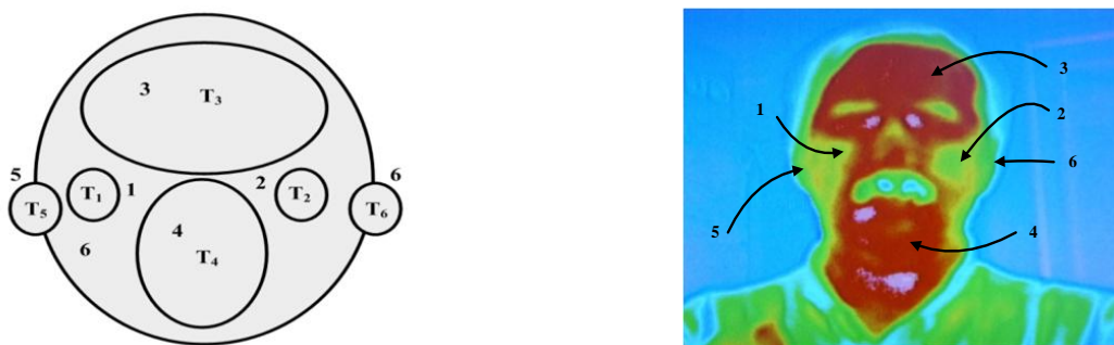
Рис. 2. Пример фрагментации инфракрасного изображения лица оператора
