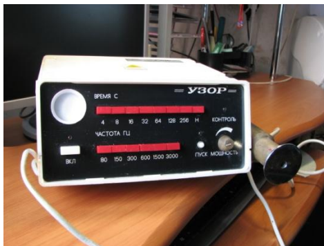
Рис. 2. Полупроводниковый лазер на арсениде галлия
