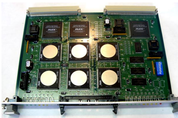
Рис. 5. Электронный модуль в стандарте Евромеханика 6U
